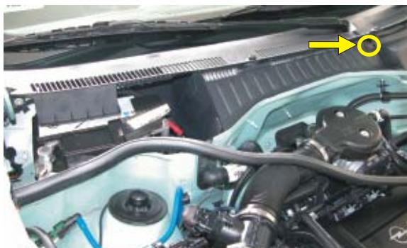
(PL) Odkręcić wkręty pokrywy filtra, usunąć pokrywę
